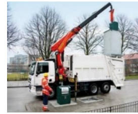
Фото. Завантаження контейнерів підземного розташування
