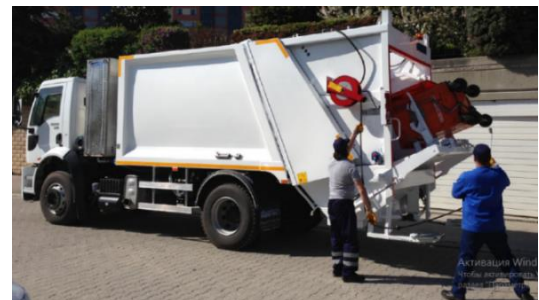
Фото. Сміттєвоз НІДРО МАК з функцією миття та дезінфекції контейнерів
