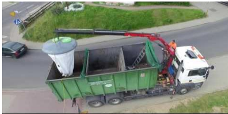
Фото. Завантаження контейнерів підземного розташування
